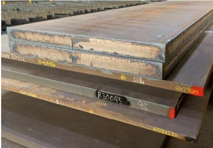
Bild 1: Speed-Auftrag für Jebens: zwei Bleche – je 7.700 Millimeter lang, 1.900 Millimeter breit und 150 Millimeter dick mit Brennschnitten.
