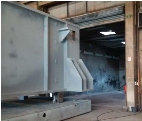
Bild 3: Das Lohnglühen im riesigen Glühofen ermöglicht es, die Werkstoffeigenschaften gewichtiger Schweißkonstruktionen zu optimieren.
