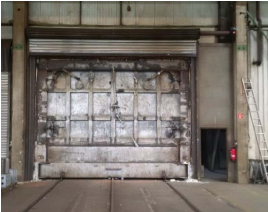
Bild 1: In dem 15 Meter langen, 5,8 Meter breiten und 3,8 Meter hohen Glühofen werden bei Jebens im Werk Nördlingen Großbauteile mit Stückgewichten von bis zu 160 Tonnen optimal auf ihren weiteren Einsatz vorbereitet.
