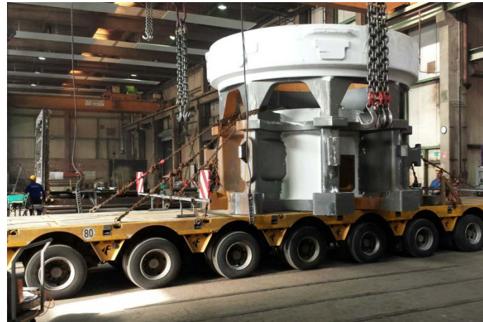
Bild 4: Getriebegehäuse aus Guss, das für einen Kunden spannungsarmgeglüht wird.
