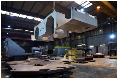
Bild 3: Bis zu 30 Tonnen schwere Elemente formen die robuste Rahmenkonstruktion der Flugzeugschlepper.
