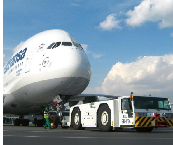
Bild 2: Das Manövrieren der bis zu 600 Tonnen schweren Flugzeuge ist ein enormer Kraftakt für die Schlepper.
