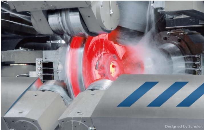
Photo 5: Depuis la presse de préformage, les ébauches arrivent vers le noyau de la ligne de forge, le laminoir de roue. Elle donne à la roue sa forme définitive.
