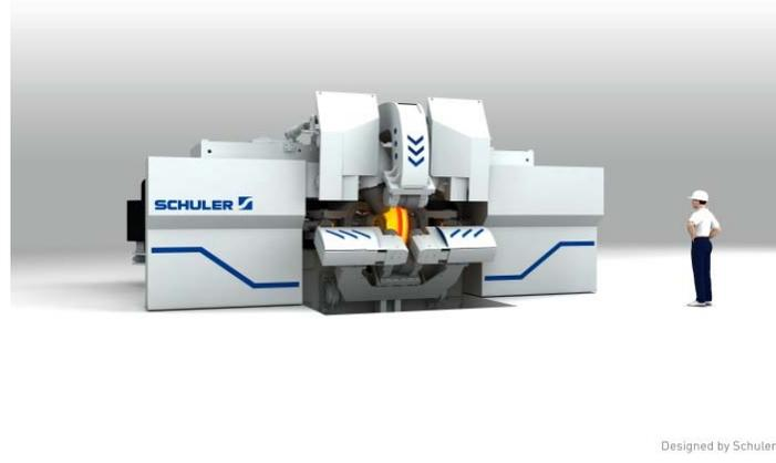
Photo 6: Dans la presse de préformage, l'ébauche de roue est forgée avec une force de pressage de 10.000 tonnes en deux niveaux de formage.
