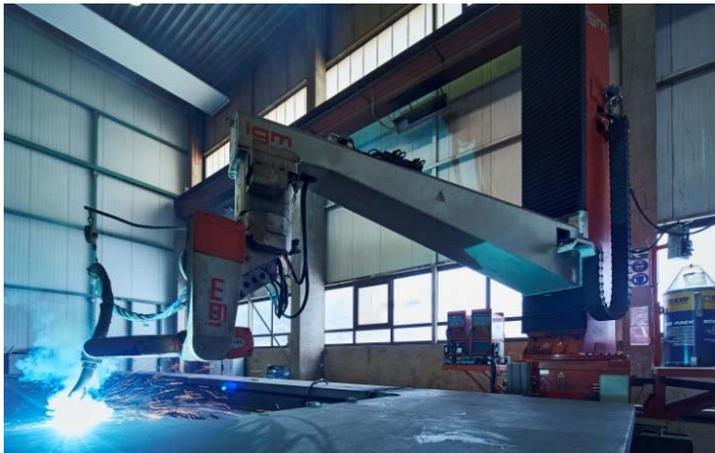
Photo 3: L'utilisation du robot de soudage a garanti, avec un soudage sur plusieurs couches, avec des cordons de soudure très réguliers et sans erreur, la précision de soudure.
