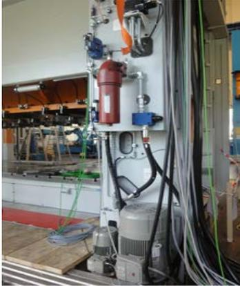
Bild 9 - 10: Ihr kompaktes Design verdanken die Servo-Pressen der Integration von Öltank und Hydraulikaggregaten in die Maschine.
