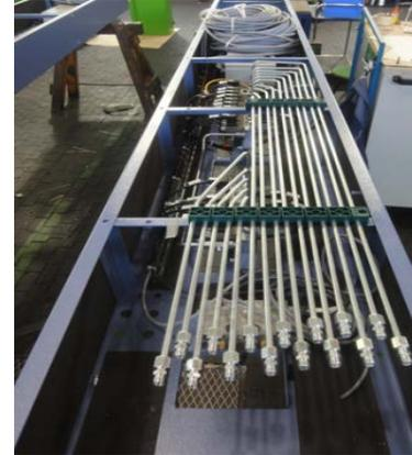
Bild 11: Die Zuleitungen für Hydraulik, Pneumatik und Schmierung sind in Installationsprofilen untergebracht.
