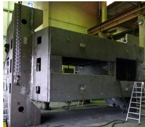
Bild 4: Präzision und Performance: Die Herstellung des Pressentischs war eine echte Herausforderung für den Schweißexperten aus Korntal-Münchingen.
