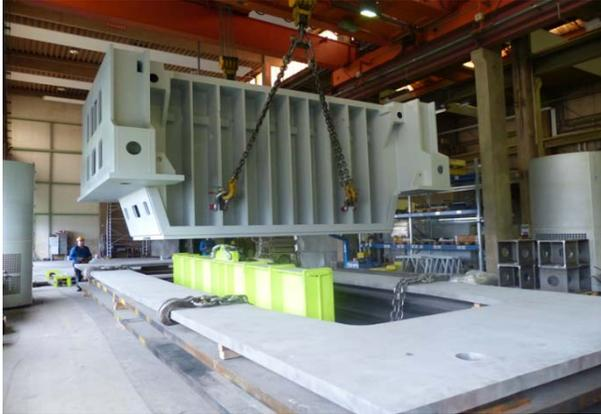
Bild 5: Koloss perfekt im Griff: Das Handling der 156-Tonnen schweren Komponenten war Maßarbeit.
