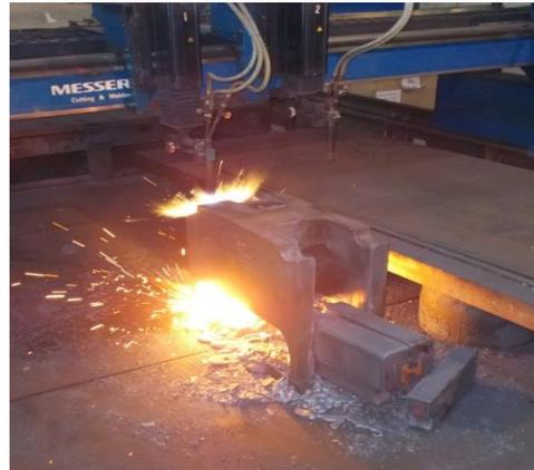
Bild 1-2: Nur mit der Flamme fertigt Jebens exakt nach Kundenvorgabe enge Radien oder Ausklinkungen mit einer Sato-Brennschneidmaschine aus bis zu 1.100 Millimeter dicken Stahlfeln oder -blöcken.
