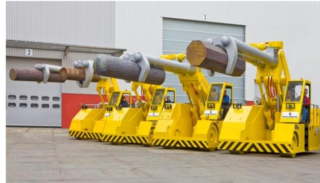
Bild 1: Die größten Schriedemanipulatoren von Dango & Dienenthal haben ein Gewicht von 1.000 Tonnen und können bis zu 250 Tonnen heben und bewegen.
