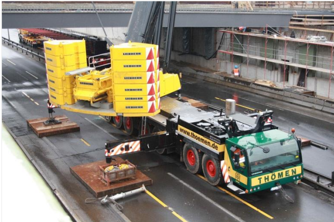
Bild 3+4: Grundplatte mit aufgeschweißten Teilen zur Aufnahme der Gussballaste.
