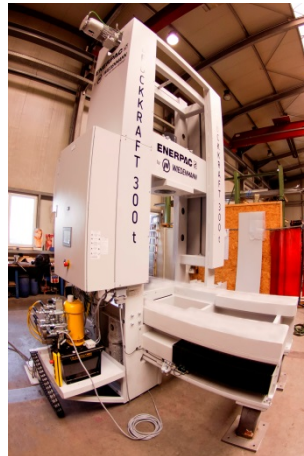
Bild 3+4: Für diese vier Meter hohe und 2,8 Meter breite Rollrahmenpresse mit 3.193 kN (300 Tonnen) Presskraft, einer Tischlänge von 3,8 Metern und 13 Tonnen Eigengewicht schweißte Jebens Pressentisch und Grundkomponenten des Oberjochs.
