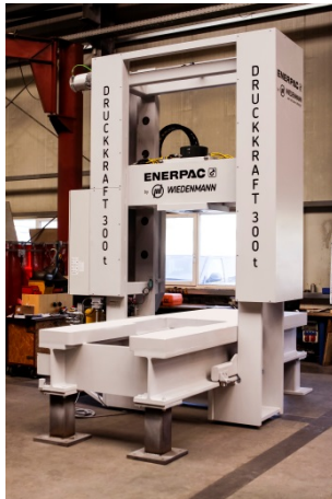
Bild 3+4: Für diese vier Meter hohe und 2,8 Meter breite Rollrahmenpresse mit 3.193 kN (300 Tonnen) Presskraft, einer Tischlänge von 3,8 Metern und 13 Tonnen Eigengewicht schweißte Jebens Pressentisch und Grundkomponenten des Oberjochs.
