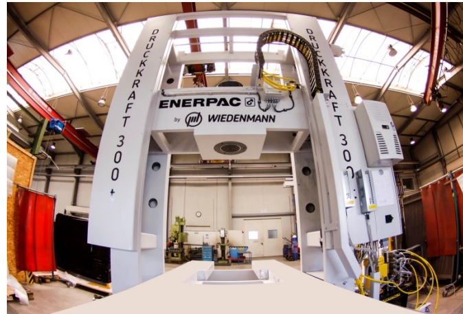
Bild 2: Mit dem Pressentisch, 11 verschiedenen Pressentischeinsätzen und den Grundkomponenten des fahrbaren Oberjochs fertigte Jebens Kernelemente der Grundkonstruktion für diese Highend-Presse.
