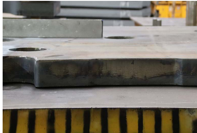
Bild 13+14: Für das Richten der 120 Millimeter dicken Bleche aus hochfestem Stahl mit der Flamme war die ausgewiesene Kompetenz der Richtmeister bei Jebens gefragt.
