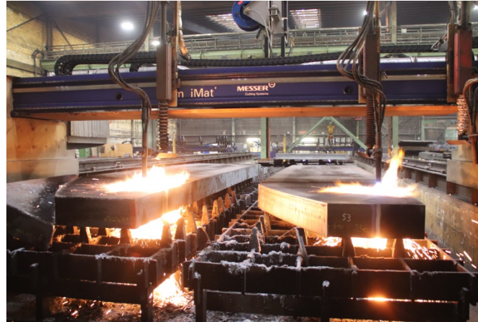
Bild 12: Das autogene Brennen erfolgte mit mehreren Brennern parallel.
