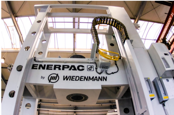
Bild 6: Das Oberjoch ist elektromechanisch in fünf Stufen à 400 Millimetern über Spindelantriebe und Bedienpaneele verstellbar.
