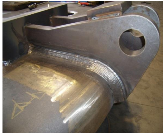
Bild 8: Insgesamt fertigte Wessel fast 550 Kilogramm Schweißnaht für die Gießpfanne.
