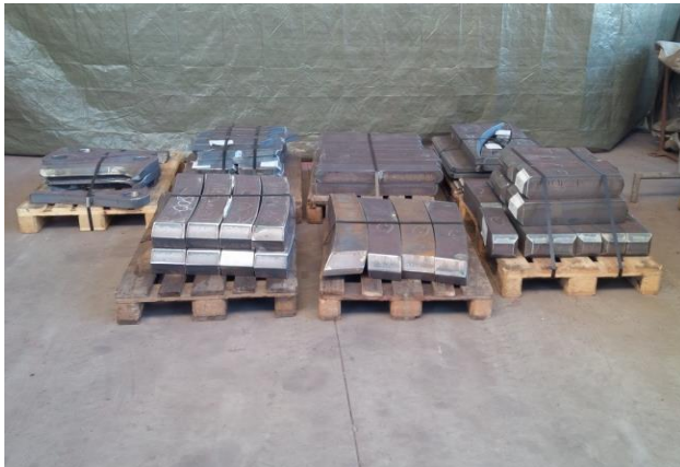
Bild 3: Zur Verstärkung der kegelförmigen Pfannengeometrie fertigte die Jebens GmbH durch 3D-Brennen 28 leicht spiralförmige Rippen.
