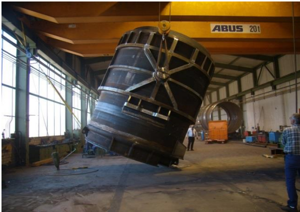
Bild 15-16: Nach der Fertigstellung brachte die Pfanne rund 24,5 Tonnen auf die Waage.
