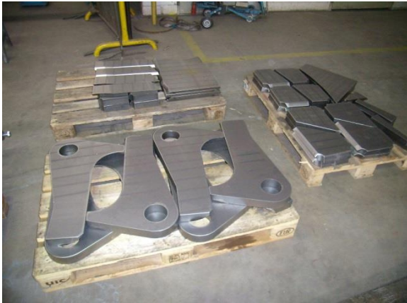
Bild 9: Jebens fertigte auch die Brennteile für die Kippvorrichtung und den Sockel.
