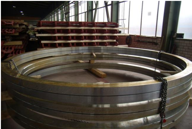
Bild 5: Massive Vollringe verstärken den konischen Pfannenmantel.
