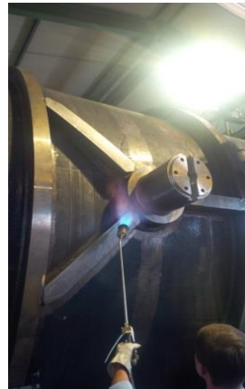
Bild 12: Beim Anschweißen der einzelnen Anbauteile arbeiteten zwölf Schweißer im Dreischichtbetrieb.
