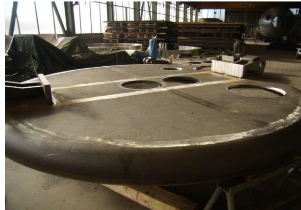
Bild 2: Der Pfannenboden mit den Löchern für Temperatursensoren, Abstich und Gasspülung.
