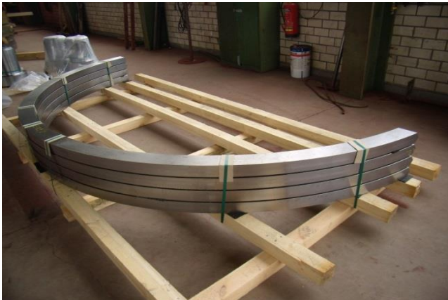
Bild 7: Auf Höhe der Tragzapfen verstärken halbmondförmige Verstärkungsringe die Pfanne.
