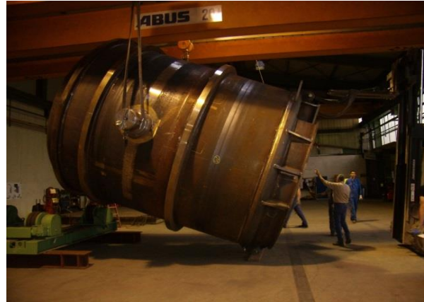
Bild 14: 3,90 Meter hoch mit fast 3,80 Meter im Durchmesser ist die Pfanne ein großes Kaliber.
