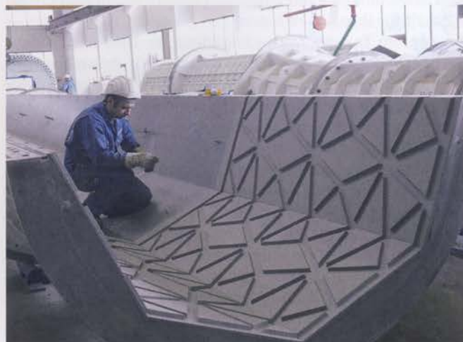
Die sternförmigen Reliefs der Moscheesäulen werden beim Schleuderprozess direkt mit geformt. Foto: Europoles GmbH & Co. KG
