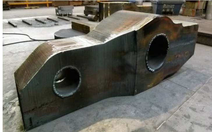
Bild 2: 960 Millimeter dicker Pressenhebel in drei Ebenen von Jebens geschnitten
