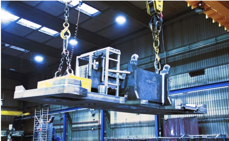
Bild 1: Bestes Beispiel für die Baumaschinenindustrie: 14,3 Tonnen schwere Krangrundplatte
