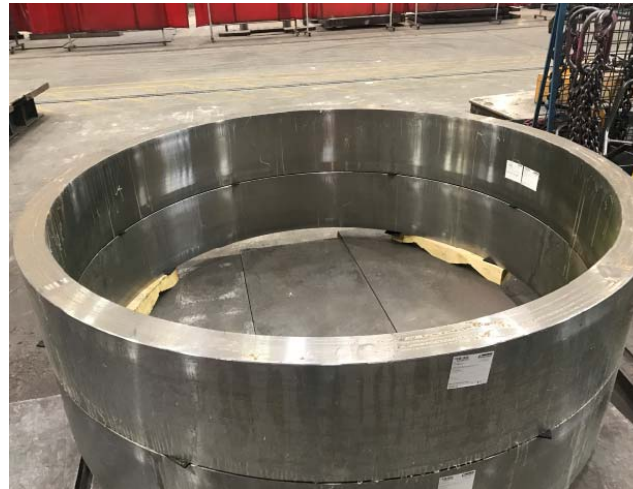
Bild 4: Beim Zusammenbau stellte Jebens durch entsprechende Kennzeichnung der Fluchtungen an den Bauteilen sicher, dass die beiden runden Komponenten auf dem Schweißstisch exakt positioniert waren.
