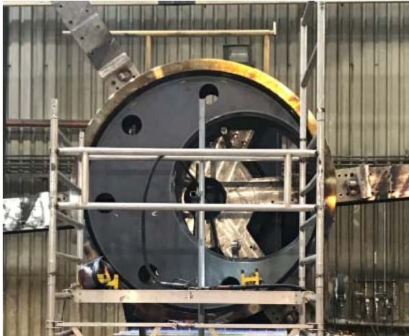
Bild 1: Eine eigens entwickelte Drehvorrichtung ermöglichte es den Zahnkranz aus 42CrMo4 QT mit den Nabenscheiben aus S235JR von vorne zu verschweißen.
