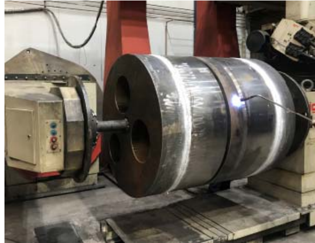
Bild 2: Jebens fertigte den Exzenterantrieb aus Blechen der Güte S235JR mit bis zu 210 Millimetern Dicke und einem Rohling aus 42CrMo4 QT.
