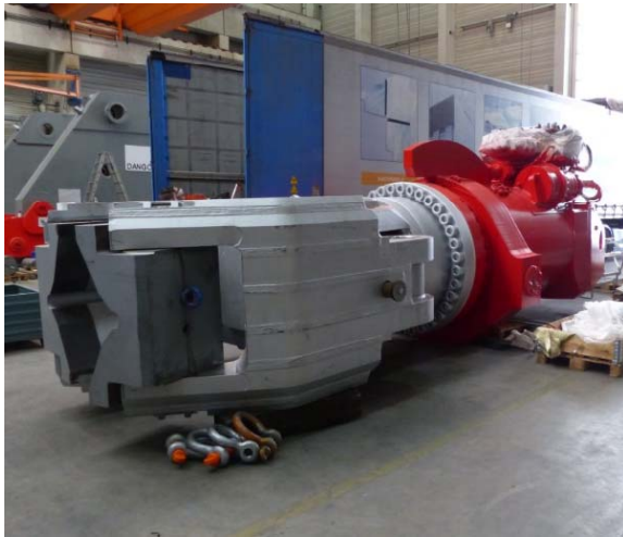
Bild 9: Die Zange mit Drehantrieb mit den von Jebens gefertigten Bauteilen im montiertem Zustand.
