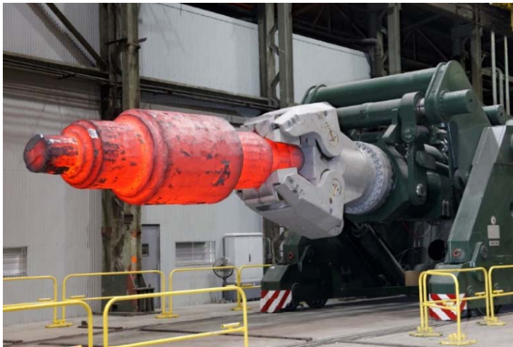
Bild 3: Jebens übernahm den Bau des speziell geformten Zangenkopfes und der Zangenschenkel sowie von Teilen des Hauptrahmens und Öltanks für den Schmiedemanipulator vom Typ SSM 2000.
