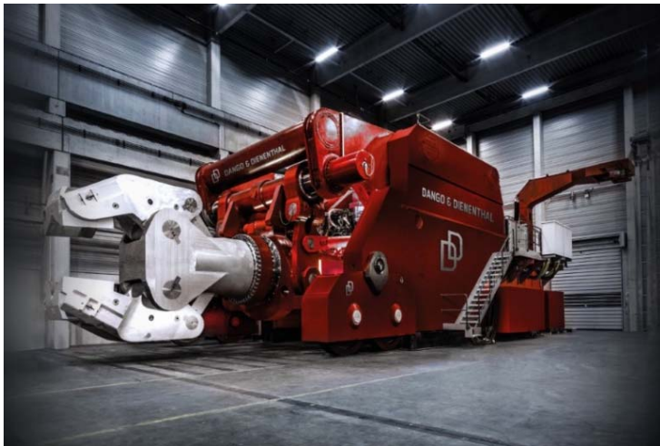
Bild 1: Für die schienegebundenen Manipulatoren von Dango & Dienenthal mit extrem hohen Traglasten liefert Jebens Zangenkopf und Zangenschenkel sowie Teile des Hauptrahmens und Öltanks.
