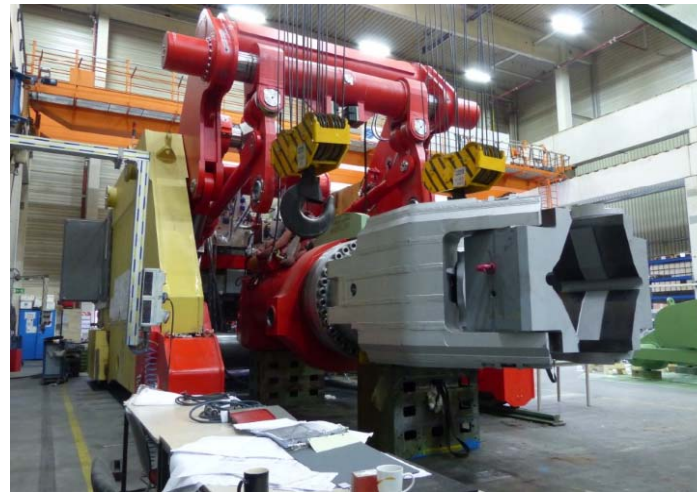
Bild 2: Für einen amerikanischen Kunden baute Dango & Dienenthal einen schienegebundenen Manipulator Typ SSM 2000 – 14 Meter lang, 5,6 Meter breit und 4,5 Meter hoch.
