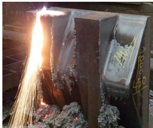
Image 4: C'est ainsi que quatre chanfreins séparés par une barre ont été réalisés dans un bloc de 450 millimètres d'épaisseur et de 1000 millimètres de haut.
