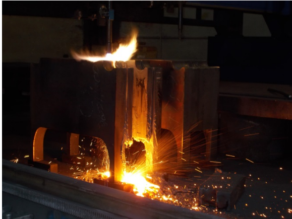
Image 1: Il fallait fabriquer en plusieurs étapes à partir d'une tôle d'acier de 30 tonnes des pièces de 400 x 710 x 840 mm et enlever de grands segments de matière à rayons serrés.
